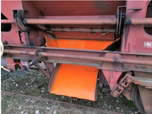
Lärmschutzmatten für Schotterwagen
