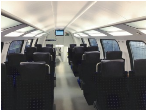
T5-Rohrleuchten im Zug
