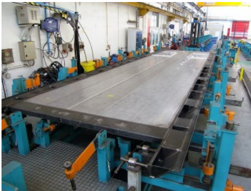
Explosionsschweißtes Verbundmetall bei Alstom Transport
