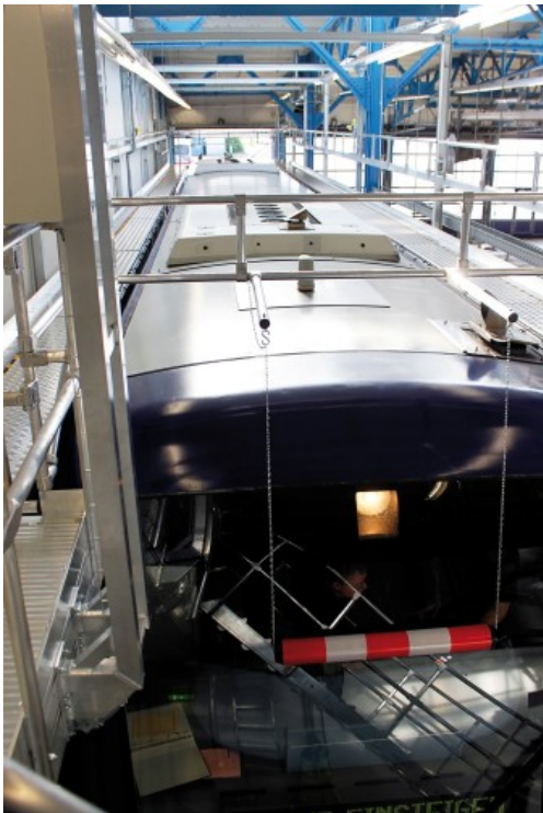
Stirnseitiges Absturzeländer, Podest mit Rammschutz noch eingefahren
